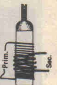
Prim. = 29 esp. 26 AWG Sec. = 4 esp. 22 AWG
