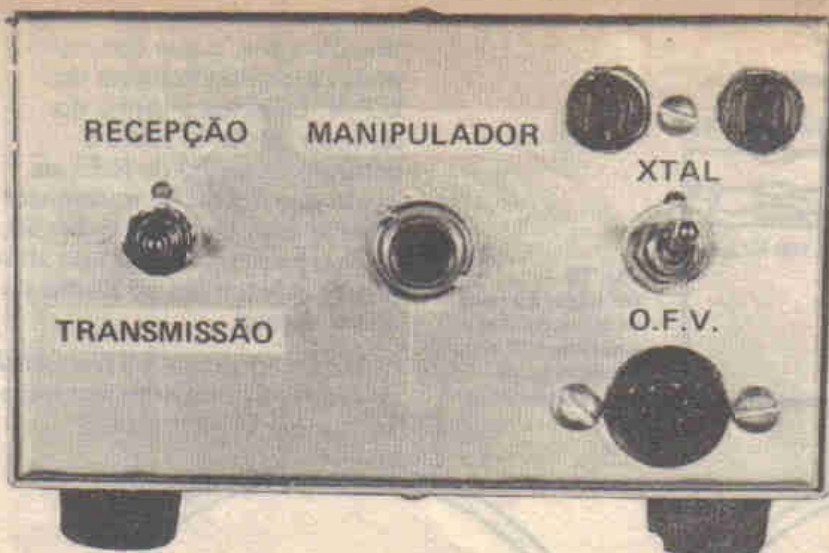
Foto 6 - Painel frontal do módulo excitador/amplificador de potência. Para uso de cristal oscilador, este será encaixado nos receptáculos acima da chave comutadora XTAL/O.F.V.
